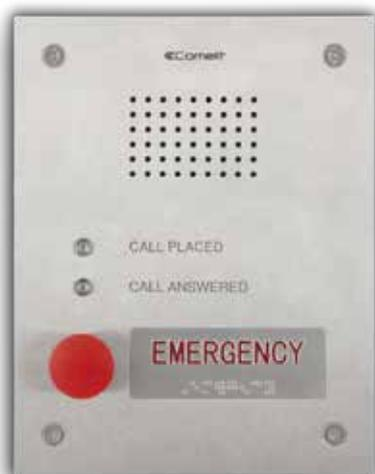
Pulsantiera in acciaio inox con singolo pulsante di chiamata e led di segnalazione per chiamata inoltrata e chiamata risposta. Completo di modulo audio art. 1682 per sistema ViP e di scatola da incasso. Modello "EMERGENCY" con indicazione braille. Installabile anche da parete con accessorio art. 3461 acquistabile separatamente.
