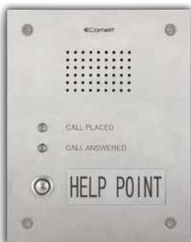
Pulsantiera in acciaio inox con singolo pulsante di chiamata e led di segnalazione per chiamata inoltrata e chiamata risposta. Completo di modulo audio POE per sistema ViP e di scatola da incasso. Modello "HELP POINT". Montabile da parete con accessorio art. 3461. Dimensioni della placca: (L x H x P): 180 x 229 x 3mm.
