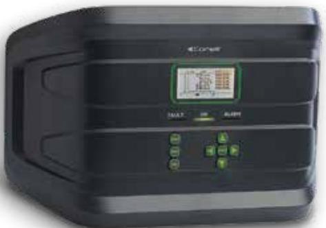
La centrale gas da parete art. 47CPG408 può gestire fino a 4 o 8 rilevatori di gas remoti. Grazie al display grafico retroilluminato presente sul frontale della centrale, si possono visualizzare i valori in tempo reale di tutti i rilevatori gas collegati ad essa. Dotata di 4 ingressi e 5 uscite a relè, espandibile fino a 8 rilevatori e 25 relè, tramite le apposite schede d'espansione. Tensione d'alimentazione 230Vca.
