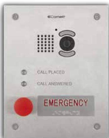
Pulsantiera in acciaio inox con singolo pulsante di chiamata e led di segnalazione per chiamata inoltrata e chiamata risposta. Completo di modulo audio/video POE per sistema ViP e di scatola da incasso. Modello "EMERGENCY" con indicazione braille. Montabile da parete con accessorio art. 3461. La pulsantiera è POE. Compatibile con formato video H264. Dimensioni 228.6x177.8x3mm.
