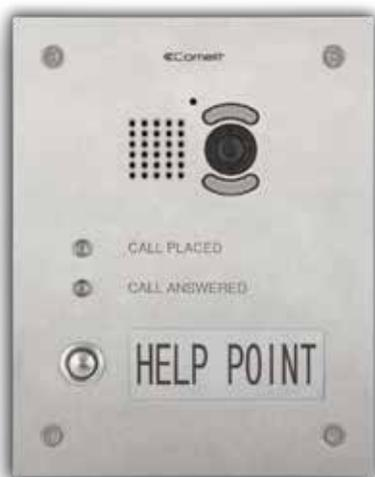
Pulsantiera in acciaio inox con singolo pulsante di chiamata e led di segnalazione per chiamata inoltrata e chiamata risposta. Completo di modulo audio/video POE per sistema ViP e di scatola da incasso. Modello "HELP POINT". Montabile da parete con accessorio art. 3461. La pulsantiera è POE. Compatibile con formato video H264. Dimensioni 228.6x177.8x3mm
